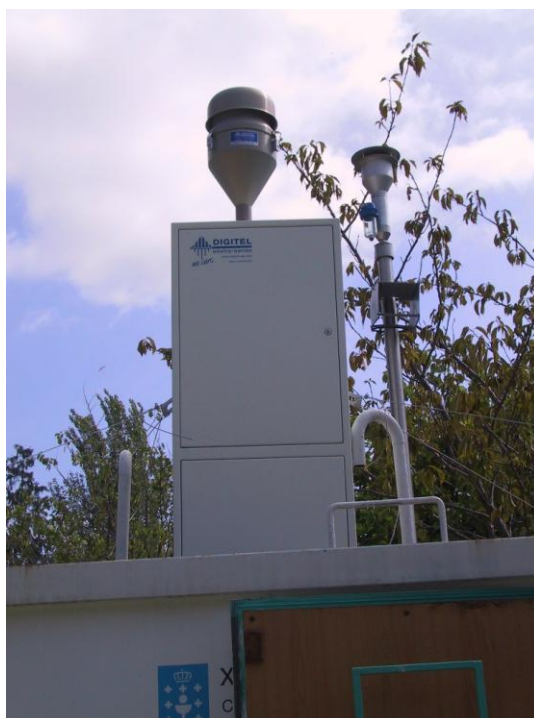
Figura 4. Captador gravimétrico en Ferrol (Parque Raíña Sofía)
