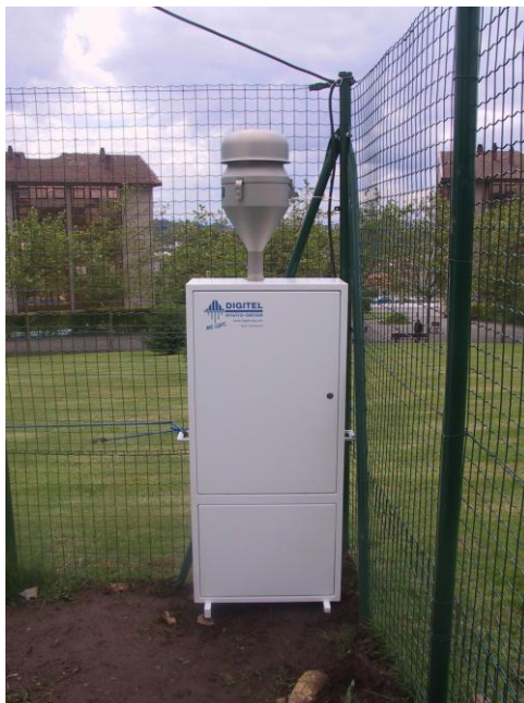
Figura 2. Captador gravimétrico en Santiago de Compostela (San Caetano)
