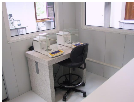
Figura 6. Sala de balanzas con temperatura e humidade controlada no IUMA (interior)
