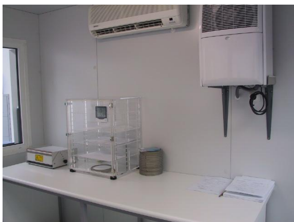
Figura 6. Sala de balanzas con temperatura e humidade controlada no IUMA (interior)
