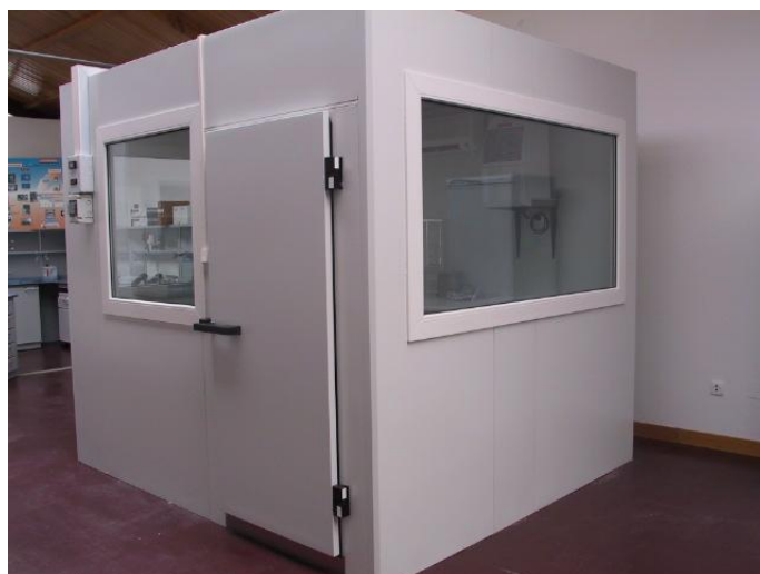
Figura 8. Sala de balanzas con temperatura e humidade controlada no IUMA (exterior)
