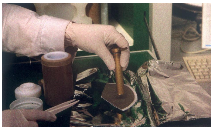
Figura 12. Procedemento de corte dos filtros
