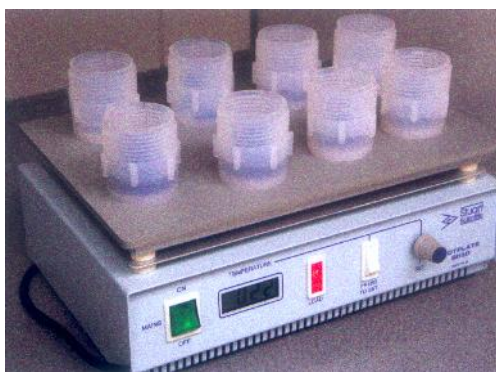
Figura 13. Placa calefactora e reactores de teflón durante a evaporación dos ácidos despois da dixestión dos filtros
