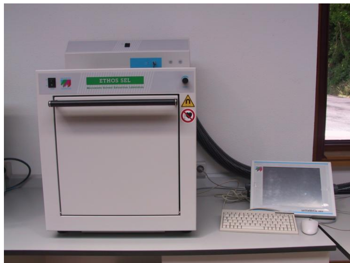
Figura 14. Forno microondas para a extracción orgánica dos filtros
