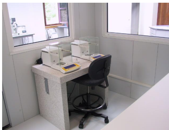
Figura 9. Sala de balanzas con temperatura e humidade controlada no IUMA (interior)
